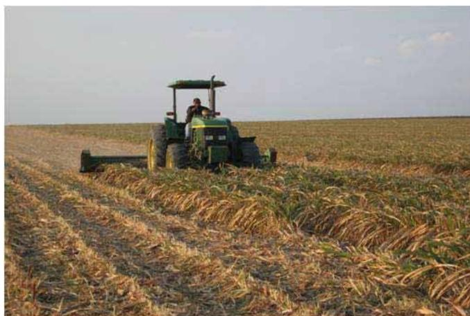
**Figura 3.** Picadora de rastrojo utilizada en sorgo, ideal para la incorporación de residuos de cosecha en labranza de conservación.
