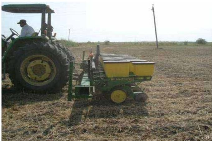
**Figura 2.** Sembradora de cero labranza.
