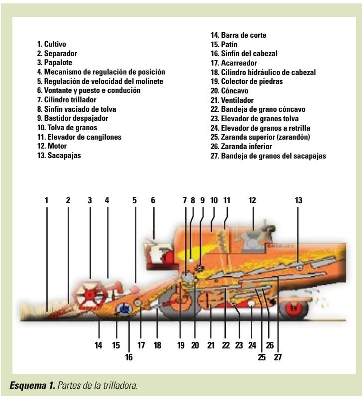
Esquema 1. Partes de la trilladora.
